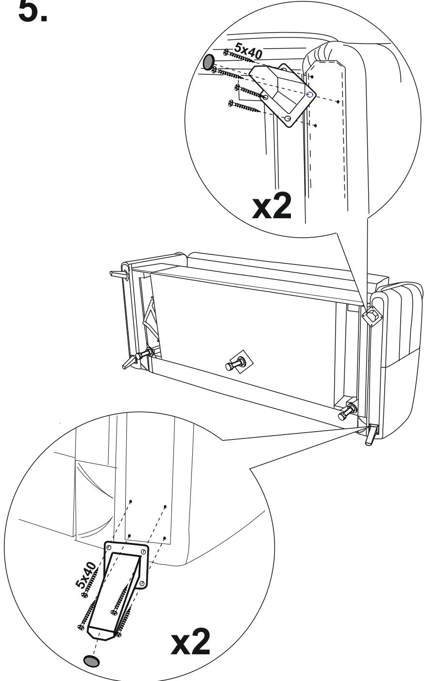
Внимание! Дополнительные опоры служат для распределения нагрузки.
