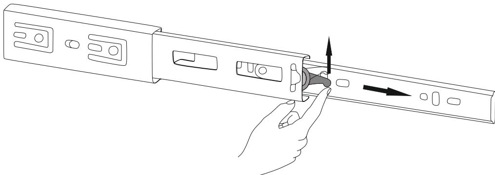
Разъединение производится путем нажатия на деблокировочный рычаг при выдвижении внутренней направляющей.
