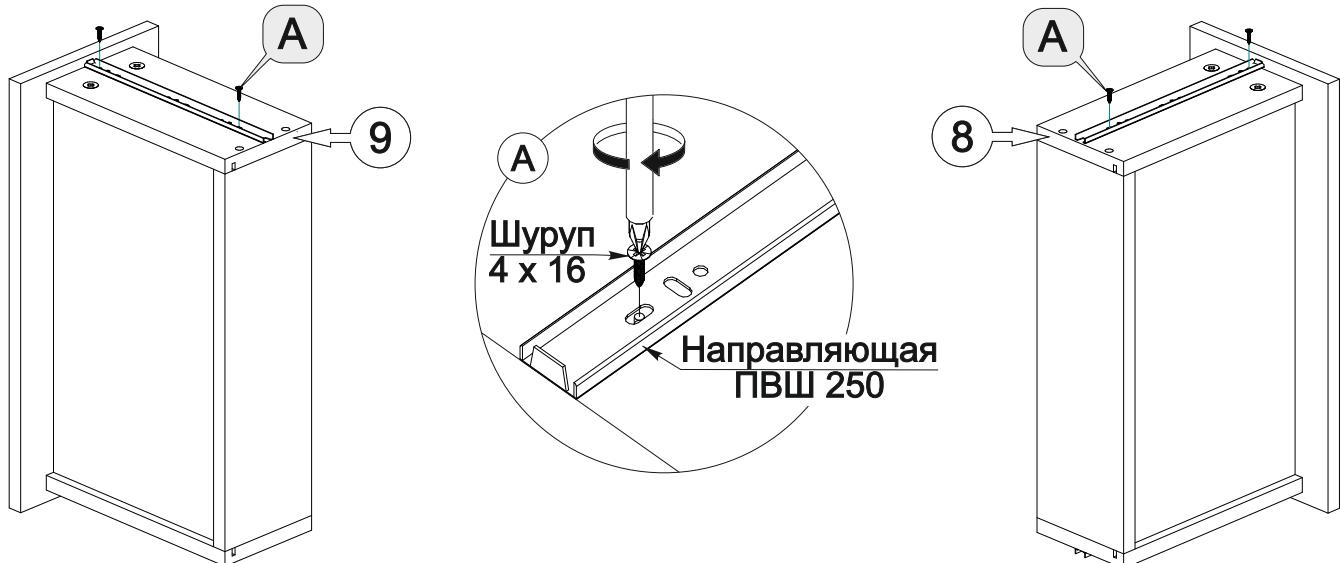
Вставить ящики внутренними направляющими в подвижные части внешних направляющих в корпусе тумбы, при этом шариковый сепаратор должен находиться в крайнем переднем положение. Задвинуть ящик до фиксации его де блокировочным рычагом.
