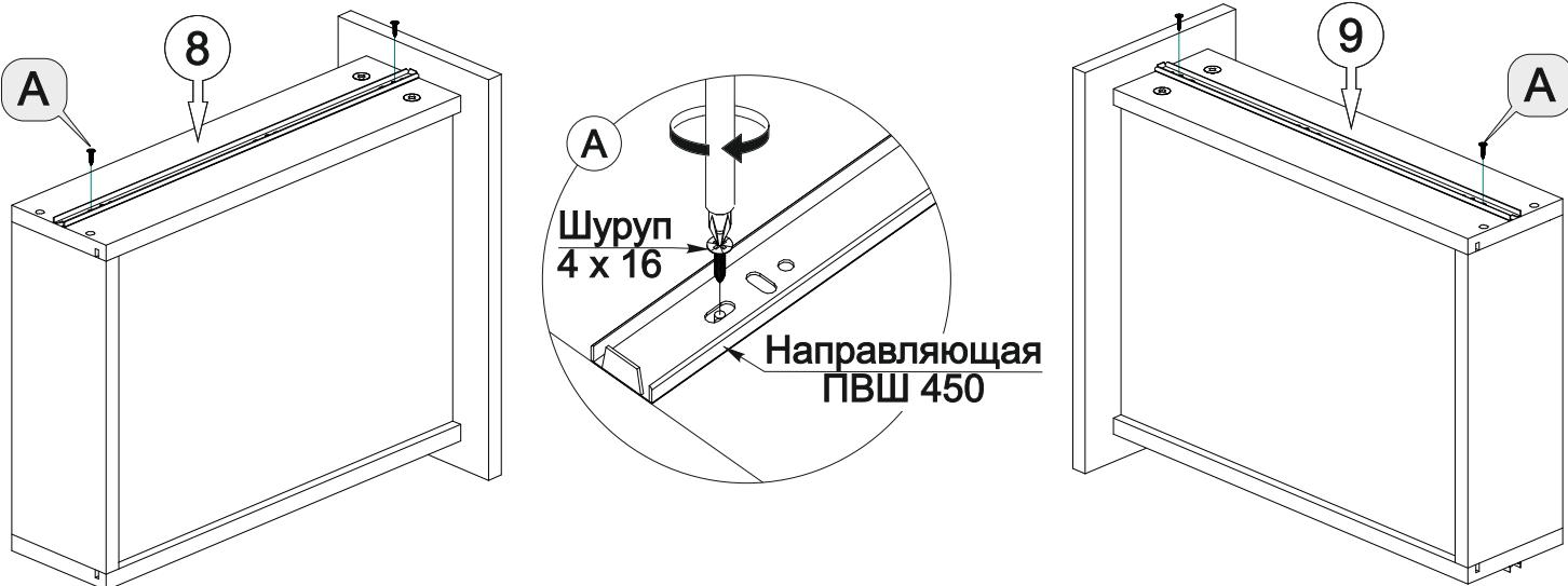
**Вставить ящики внутренними направляющими в подвижные части внешних направляющих в корпусе тумбы, при этом шариковый сепаратор должен находиться в крайнем переднем положение. Задвинуть ящик до фиксации его де блокировочным рычагом.**
