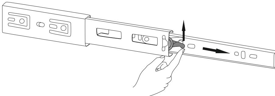
Разъединение производится путем нажатия на деброкировочный рычаг при выдвижении внутренней направляющей.
